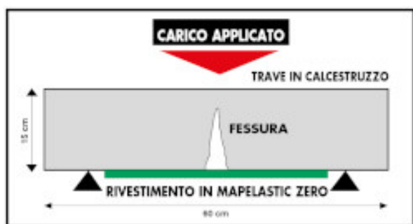
Fig.1: Beskyttelse med Mapelastic Zero af en revne på undersiden af en betonbjælke, der udsættes for en bøjningsbelastning
