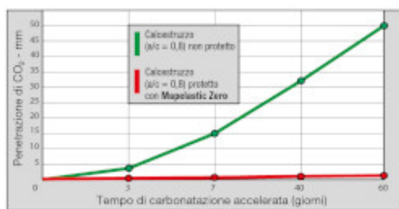
Fig. 2: Effekt af Mapelastic Zero på accelereret karbonatisering (30% CO 2 ) i en porøs beton
