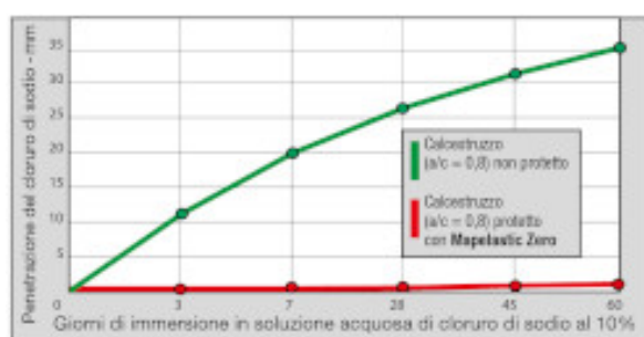
Fig.3 Effekt af Mapelastic Zero på indtrængning af natriumklorid i en porøs beton
